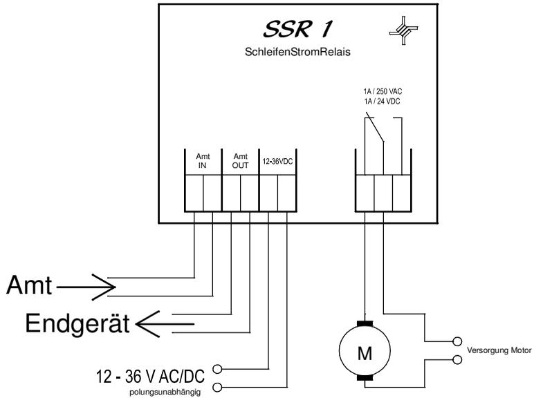
Der Motor wird abgeschaltet, solange das Endgerät ans Amt geschaltet ist.
