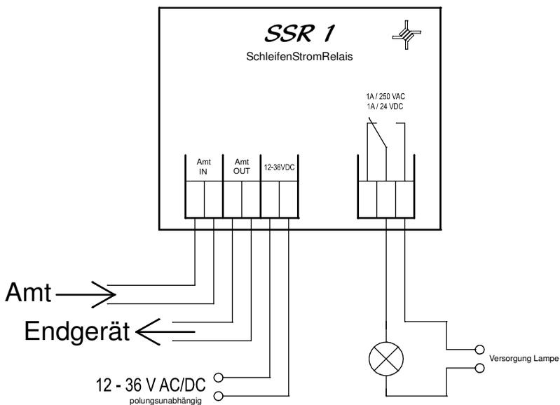
Die Lampe wird versorgt, solange das Endgerät ans Amt geschaltet ist.
