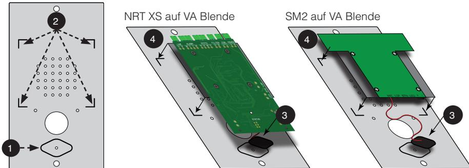
Auf der Rückseite der VA-Blende finden Sie zwei Markierungsflächen als Positionierungshilfe für das Mikrofon und NRT / SM2. Reinigen Sie die zwei markierten Flächen (1) und (2) mittels des beiliegenden Reinigungstuchs.
