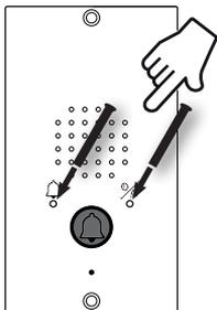
Bei VA-Blenden mit Piktogrammanzeigen liegen zusätzlich zwei Lichtleiter bei. Diese dienen dazu das abgestrahlte Licht der LEDs (siehe Bedienungsanleitung Grundgerät, Seite 6, Punkt 8+9) an die Gehäusefront zu leiten.
