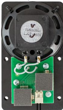
Direkt am Lautsprechermodul kann eine Notruftaste angeschlossen werden. Das Schaltverhalten der Taste (NO/NC) kann an den entsprechenden Schiebeschaltern am Notrufgerät eingestellt werden. Hier ist darauf zu achten, dass die Zuleitung vom Notruftaster möglichst kurz und ohne Umwege direkt am Lautsprechermodul angeschlossen wird.
