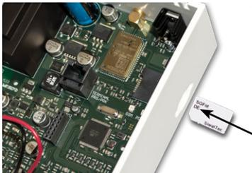
Schieben Sie die SIM-Karte wie abgebildet in den Halter, bis diese spürbar einrastet.
